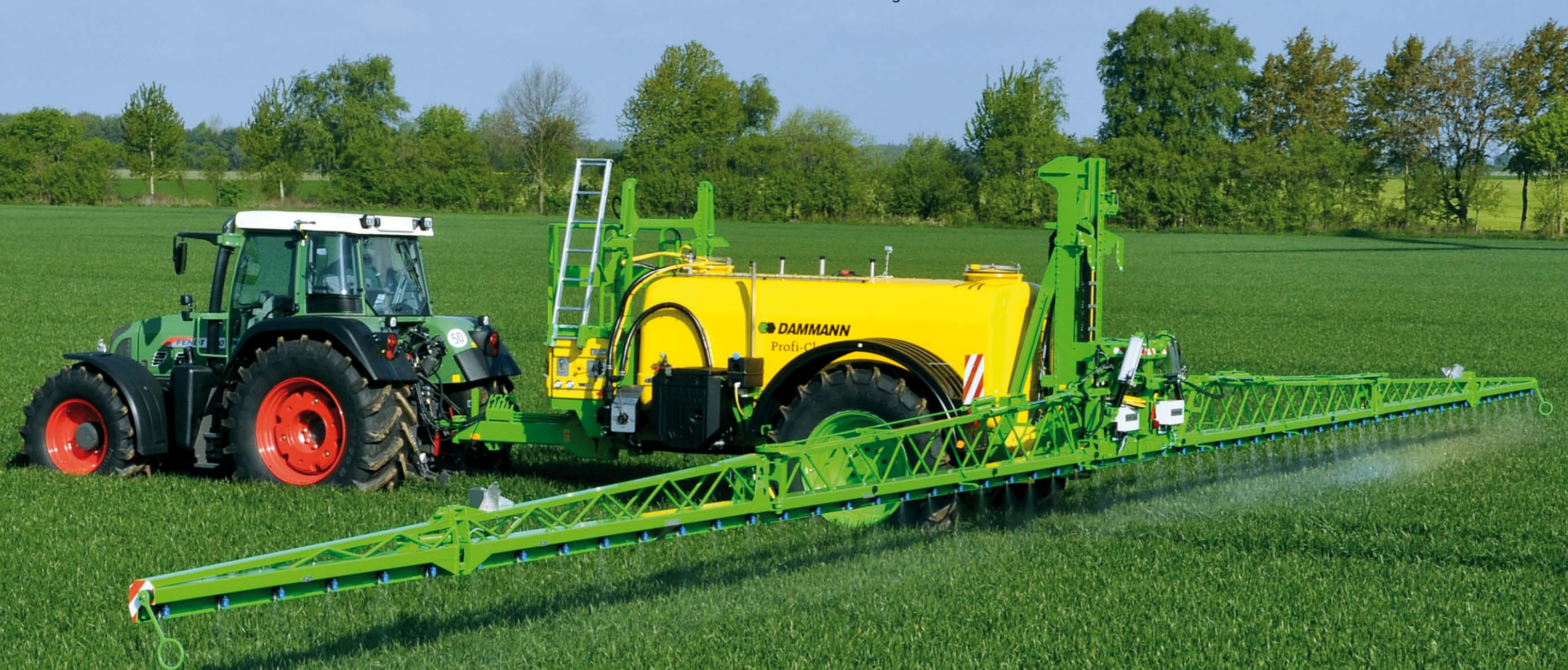
Pneumatikus fúvókavezérlés, kettős vagy négyes fúvókatartrónál, multifunkciós kapcsolási lehetőség.
