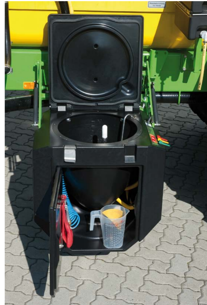
Tároló hely a védőkesztyűnek, mérőhengernek és egy levegős tisztítópisztolynak.
