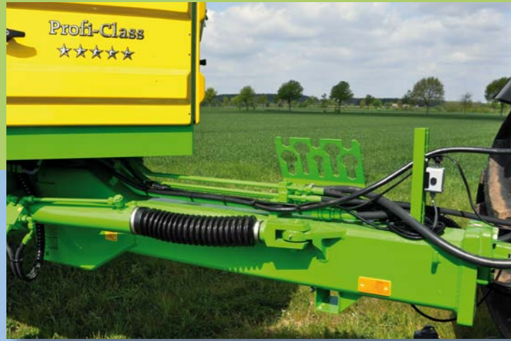
Nyomkövető kormányzott vonórúd, automatikus vagy kézi vezérléssel.(opció)
