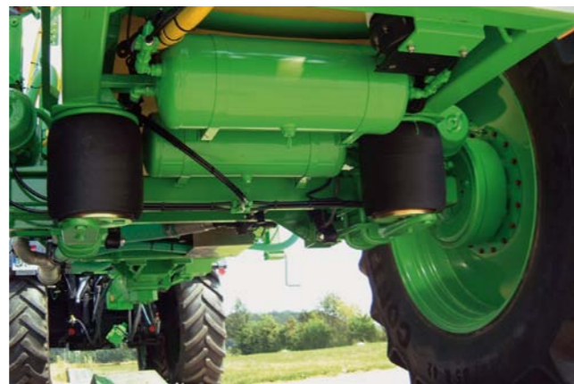
Extra hosszú úttal rendelkező pneumatikus rugózású futómű (opció)
