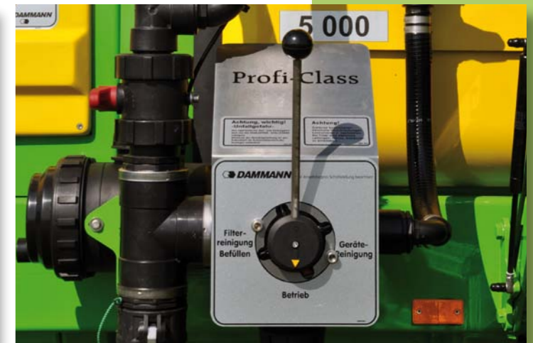
Központi kezelőegység 3" méretű töltőcsatlakozással.
