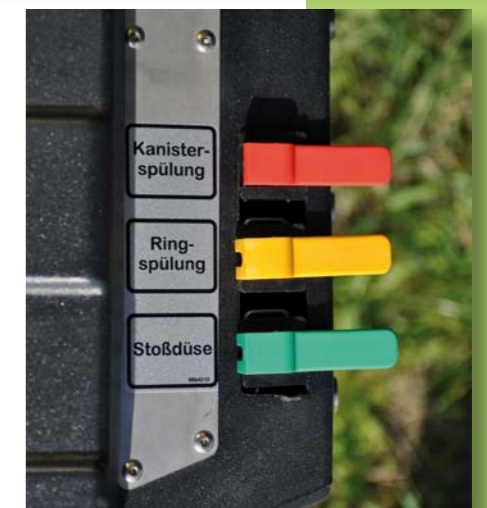
Új, süllyesztható 60 l vegyszerbekeverő központ, kezelő és adagoló csapokkal.
