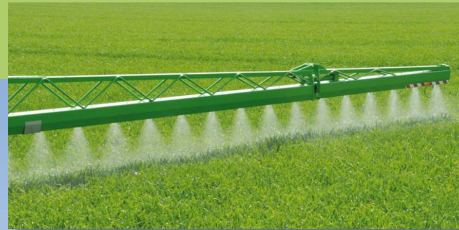
Stabil kialakítású hidraulikus nyitású szórókeret, védetten elhelyezett fúvókatartókkal, szállítási biztosítással.
