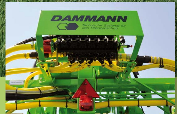
Jó minőségű, elektromos működtetésű keretszakaszolás.
