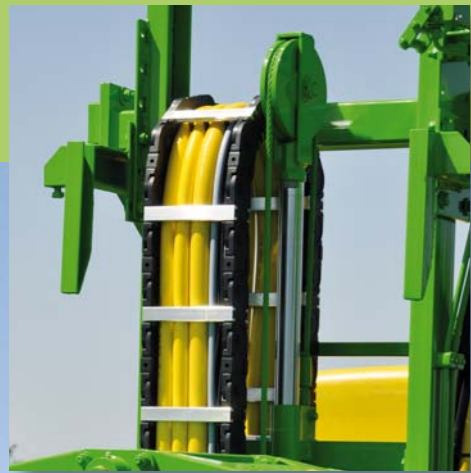
Vezetőláncban elhelyezett nyomócsövek az emelőtoronynál.
