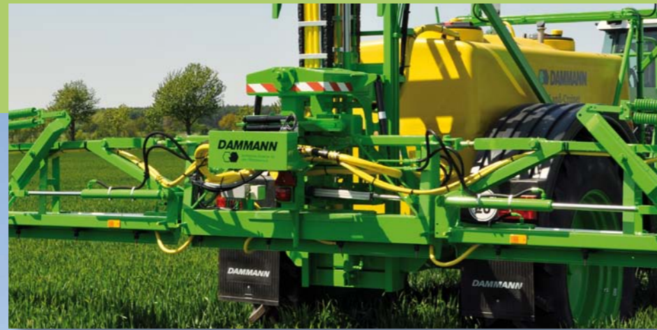
Keretfelfüggesztés. Minden méretben nagy stabilitást és csillapított keretmozgást eredményez. Az alapkivitel optimális szóráségyenletességet biztosít.
