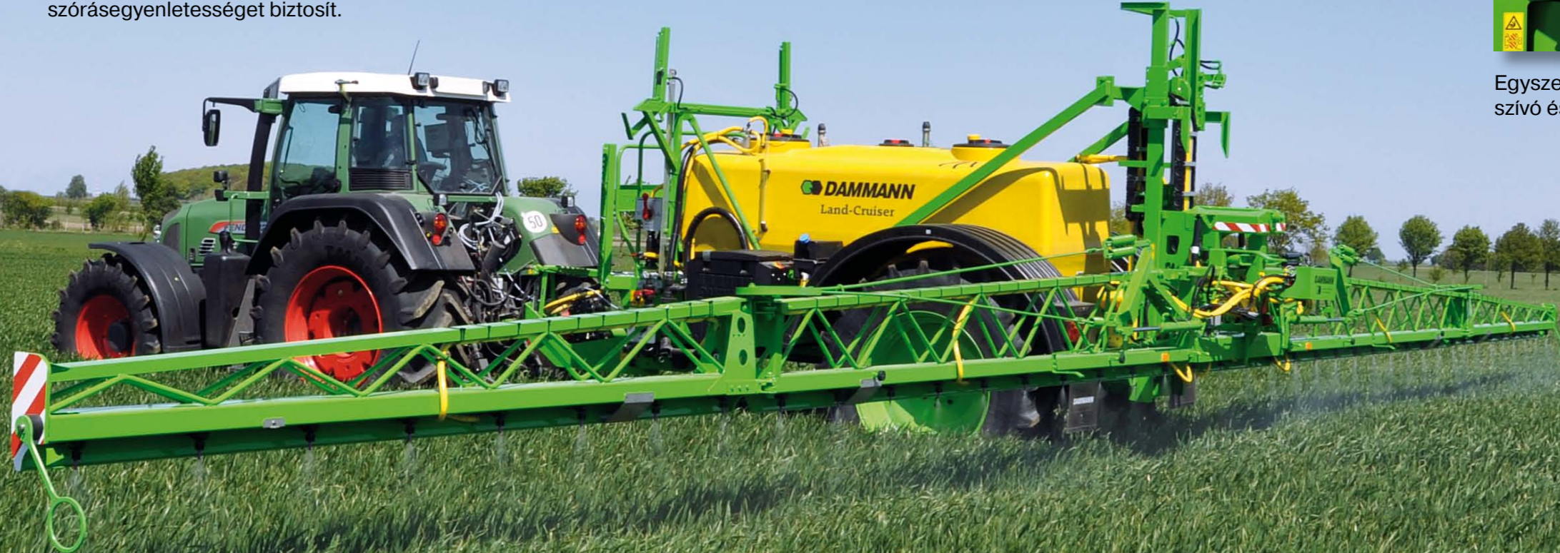
Stabil kialakítású hidraulikus nyitású szórókeret, védetten elhelyezett fúvókatartókkal, szállítási biztosítással.
