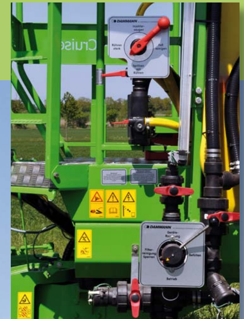
Egyszerű kezelhetőség, a központi szívó és nyomócsapokkal.
